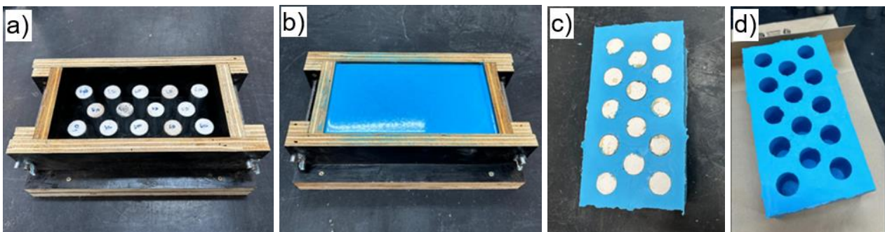
Figura 32 – Fabricación de moldes de silicona para cuerpos de prueba 25 mm x 50 mm
