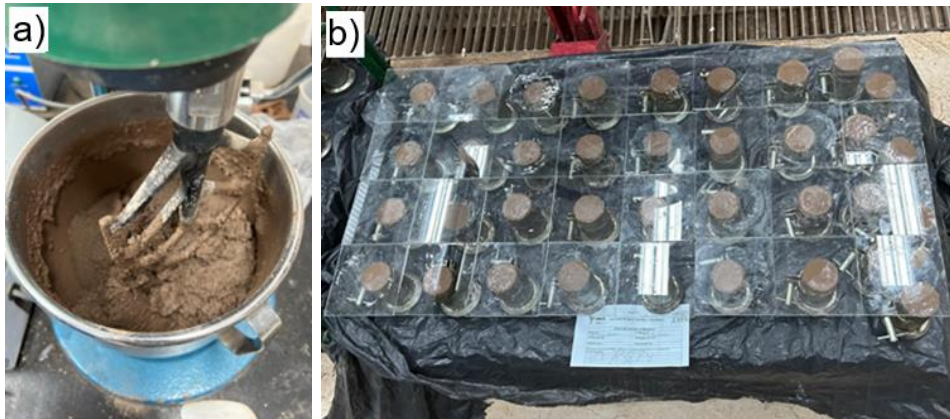
Figura 37 – Producción del mortero (a) y moldeo de cuerpos de prueba de mortero (b)
