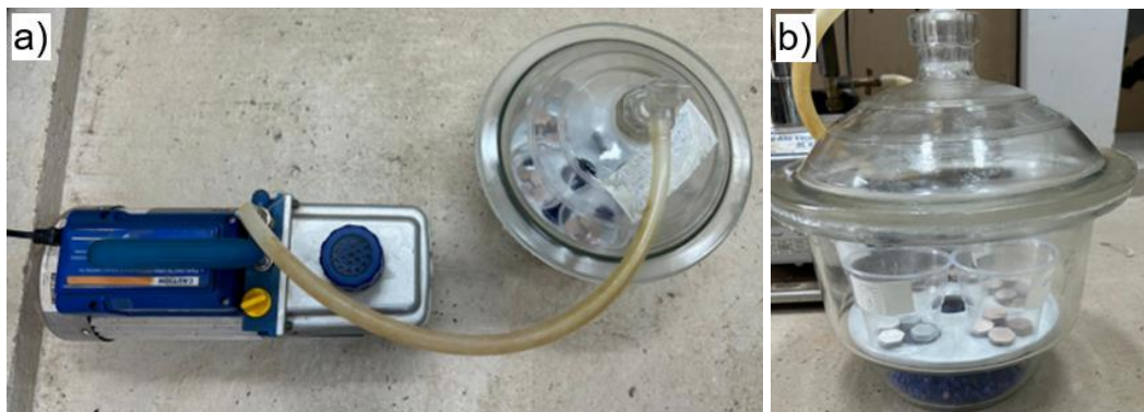
Figura 35 – Desecador al vacío acoplado con bomba de vacío (a) y muestras de pasta de cemento en el desecador (b)
