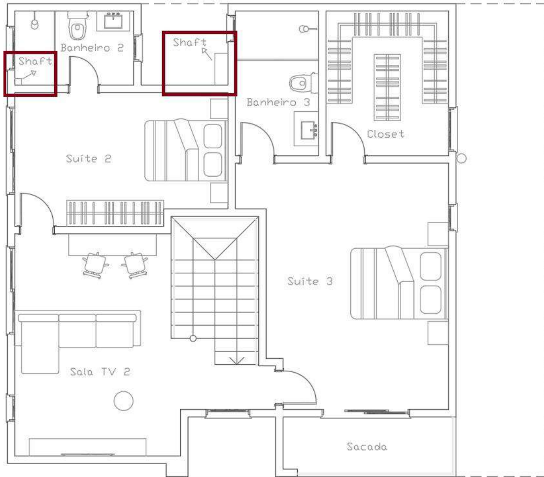
Figura 23 - Indicação dos shafts no pavimento superior
