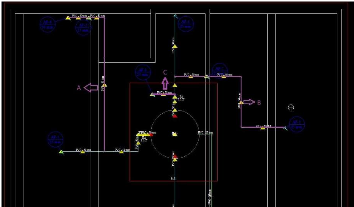
Figura 62 - Indicação dos caminhos A, B e C considerados para mudança dos diâmetros
