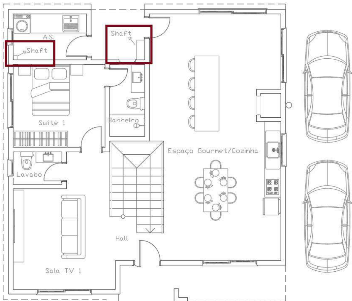
Figura 22 - Indicação dos shafts no pavimento térreo
