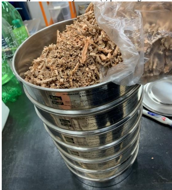
Figura 4.5 - Conjunto de (a) peneiras granulométricas e (b) agitador de peneiras.
