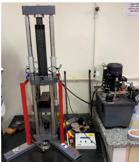
Figura 4.12 - máquina SM100 UNIVERSAL MATERIAL TESTING MACHINE CAP. 100 kN (10 t) da TQ
