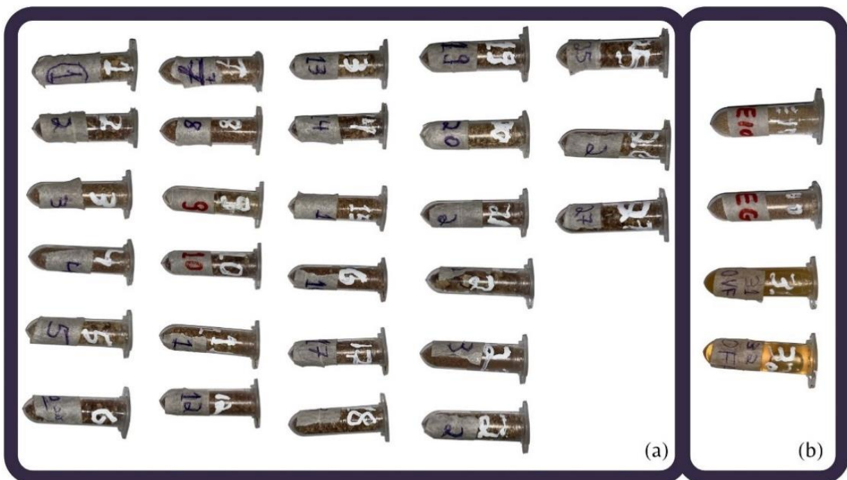
Figura 4.7 - Amostras para TGA armazenadas em Microtubos Eppendorf. (a) 27 amostras do planejamento experimental; (b) 4 matérias-primas puras.
