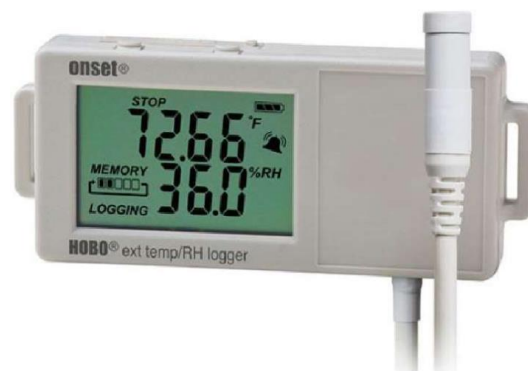
Figura 29. Equipamento utilizado para as medições (Data Logger Hobo UX100-023, marca Onset).
