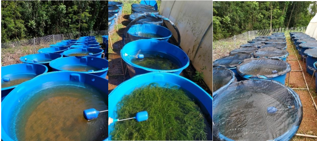
Figura 2: Mesocosmos em tanques de 500L. A) Macrófitas recém-plantadas. B) Macrófitas após cinco meses. C) Forma de sombreamento 50%.
