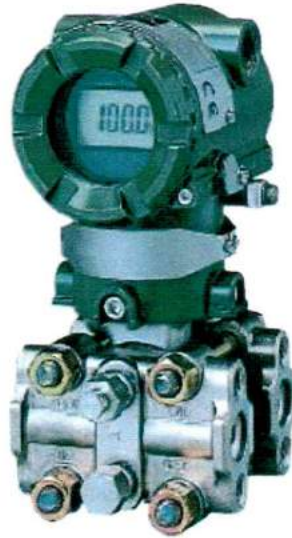
Figura 14 - Transmissor de pressão em Colombari (ITAI, 2011)
