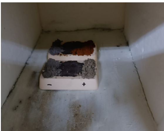
Figura 12: Pastilhas antes de serem sinterizadas a 1100 °C
