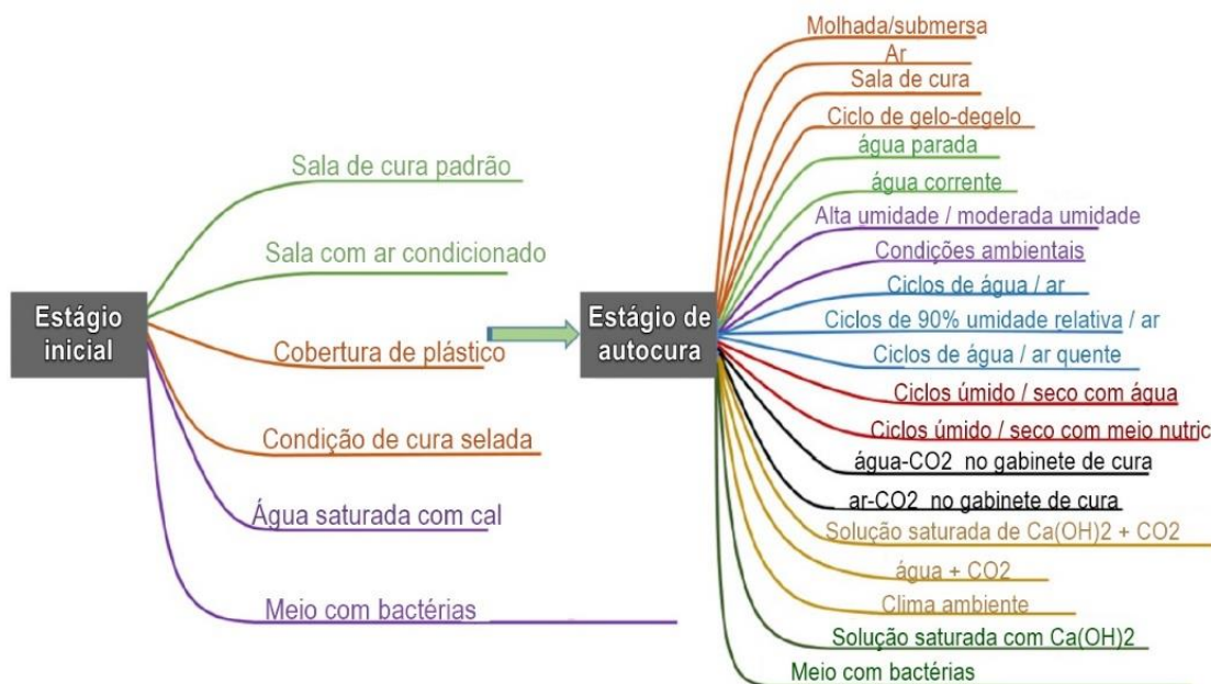
Figura 17 – Condições de cura em estágio inicial (antes do desmolde e fissuração) e de autocicatrização.
