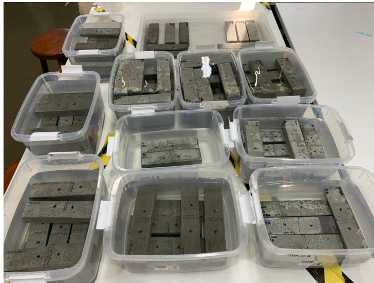
Figura 32 – Cura das amostras prismáticas fissuradas, separadas por variação de bactéria e nutrientes
