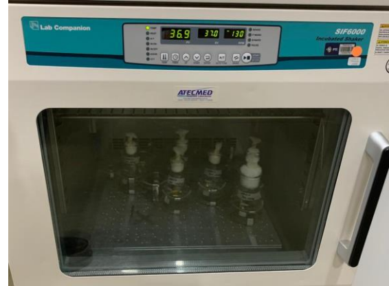
Figura 29 – Shaker em agitação dos frascos Erlenmeyers contendo as bactérias
