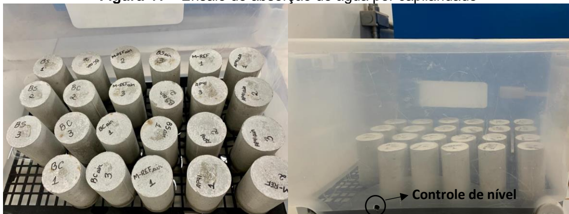
Figura 41 – Ensaio de absorção de água por capilaridade
