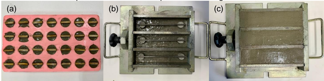
Figura 31 – Processo de moldagem de amostras armadas (a) espaçadores de pasta cimentícia; (b) espaçadores e armadura posicionados a 1cm da base sobre um lastro de argamassa; (c) preenchimento do molde prismático com argamassa
