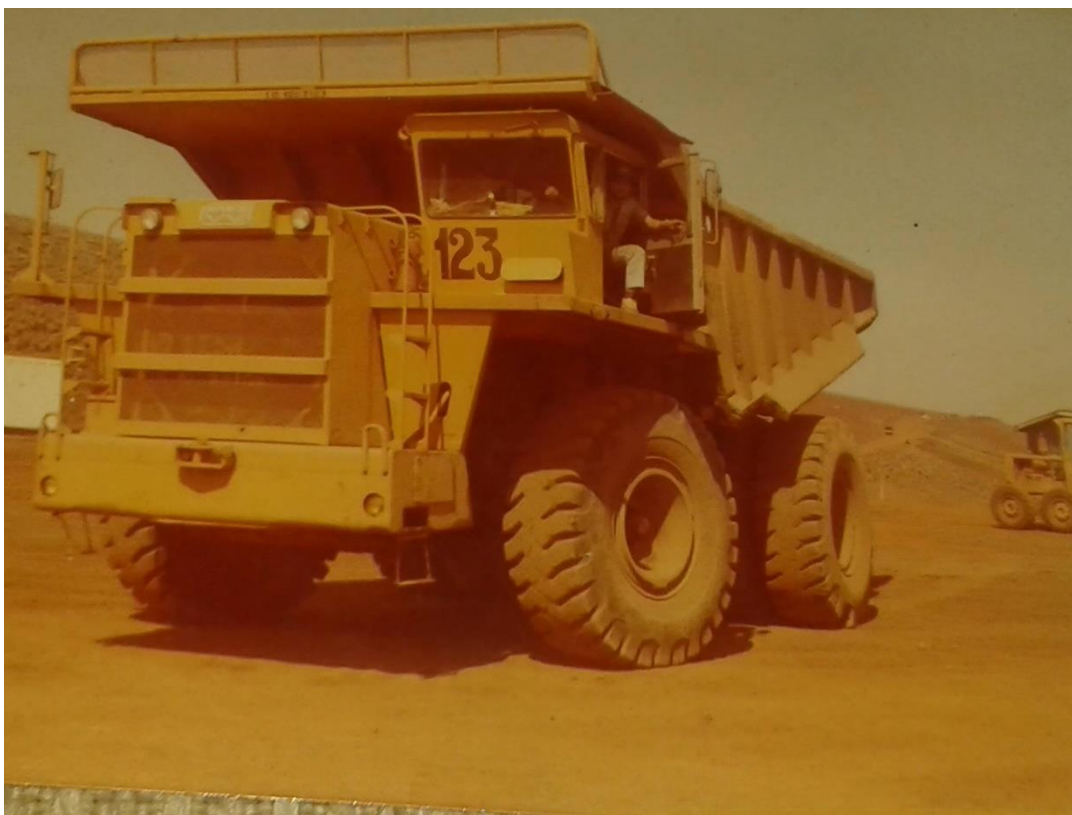
Figura 20: Fotografia 12 – Máquinas de Itaipu: caminhão Wabco 50t, o “Sansão”
