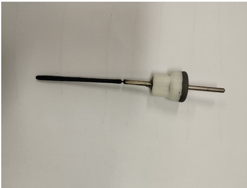
Figura 62: Deterioração do contra eletrodo após 5 horas de teste
