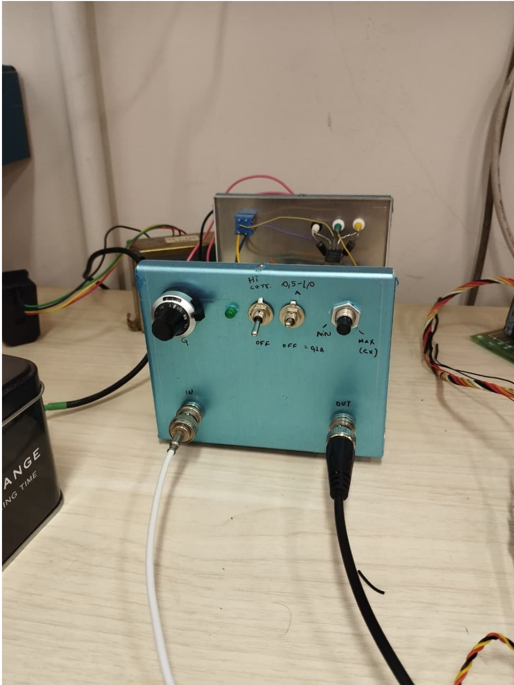
Figura 40: Buffer de potência em caixa de alumínio contendo o OPA541, com ganho ajustável entre 1 e 11, configurado para ganho unitário. O conjunto inclui chaves e potenciômetro para ajuste do limite de corrente em até 1 A. A caixa também abriga o estágio de alimentação, composto por um retificador de onda completa (limitado a 3 A) e capacitor de filtro de 10 000 \mu\text{F} . O transformador é conectado externamente à caixa
