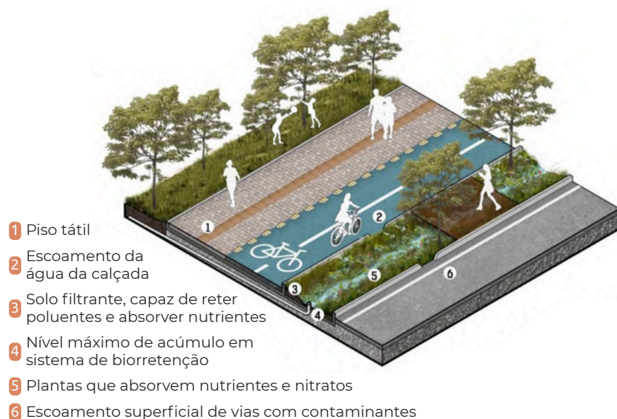
Figura 111: Esquema da configuração de uma biovaleta. Fonte: ALCUADRADO Arquitetos + Habitar, s.d.
