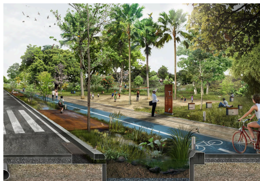
Figura 112: Corte esquemático de biovaleta. Fonte: ALCUADRADO Arquitetos + Habitar, s.d.
