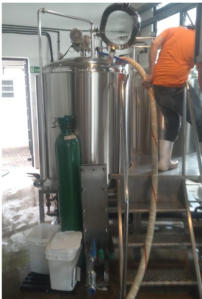
Imagem 3 - Retorno do mosto acidificado para a tina de fervura.
