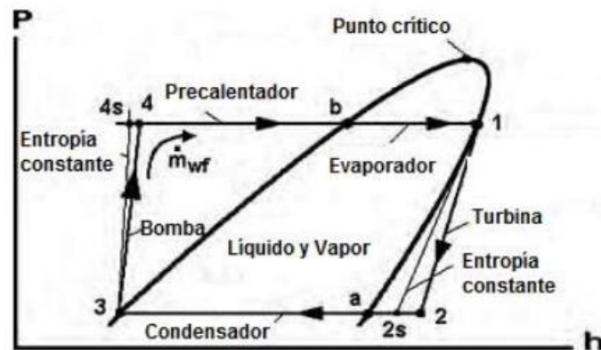
Figura 12. Diagrama presión-entalpía para una planta binaria básica.
