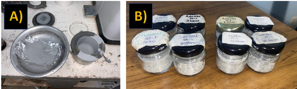
Figura 13 - (A) Remoção do compósito da folha metálica após ser secado. (B) - Armazenamento do compósito para análises.
