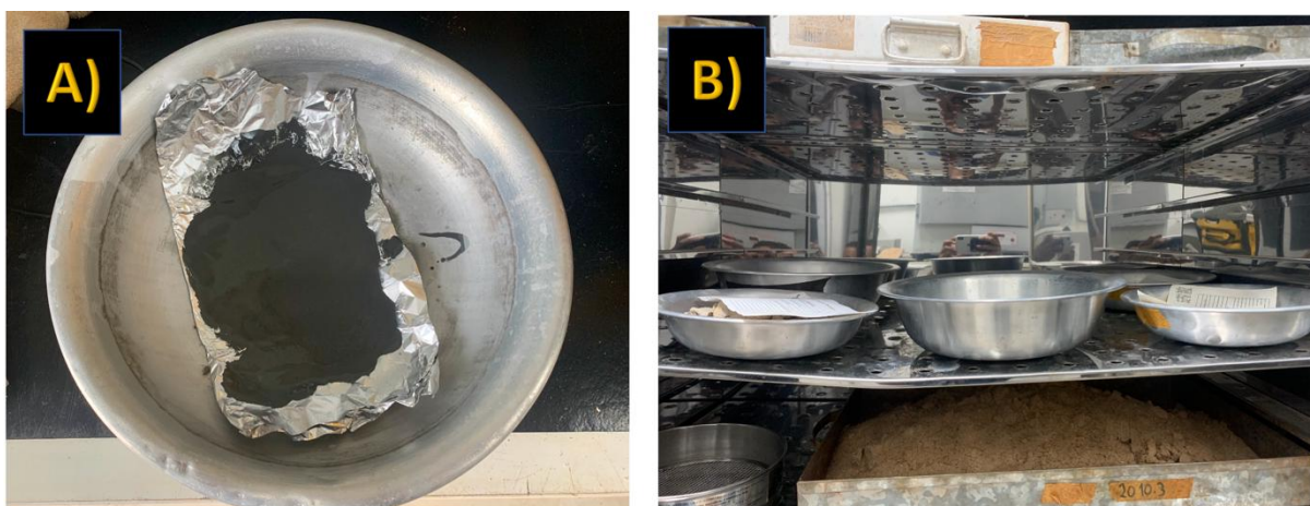
Figura 12 - (A) Amostra do compósito sobre a folha metálica para secagem. (B) - Estufa de secagem.
