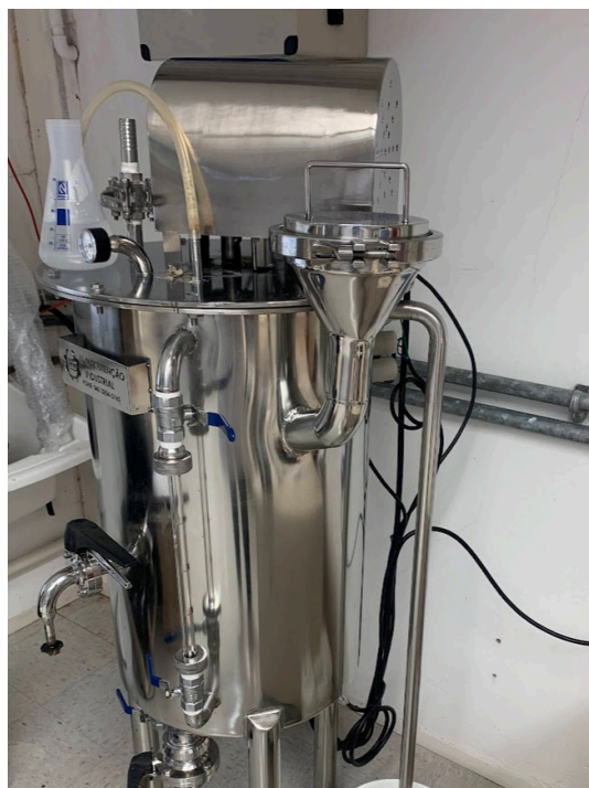
Figura 4: Reactor anaeróbico para cultivo de inóculo
