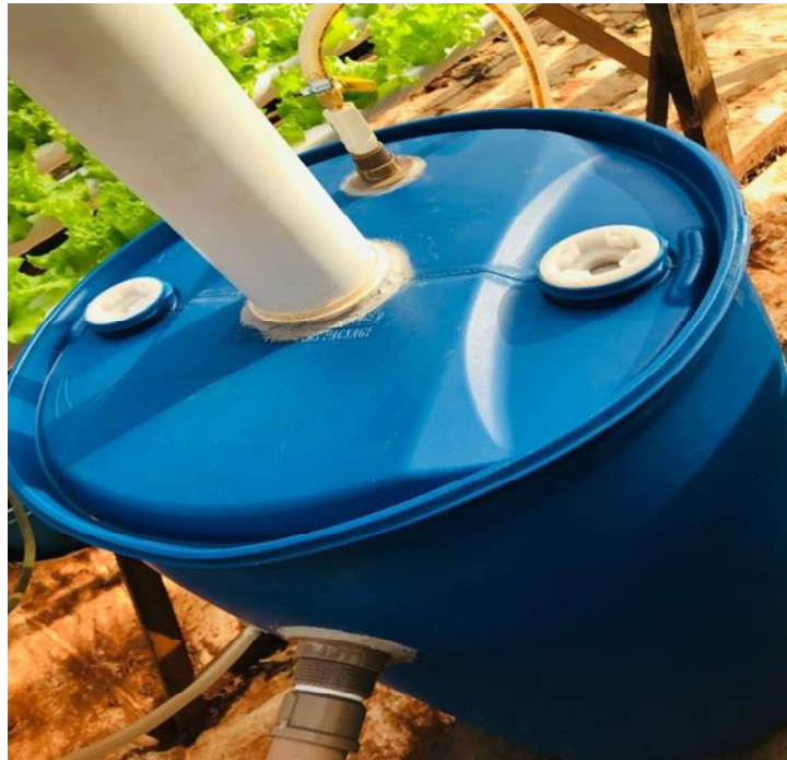
Figura 10: Entrada de biomasa, salida de gas y salida de biofertilizante.
