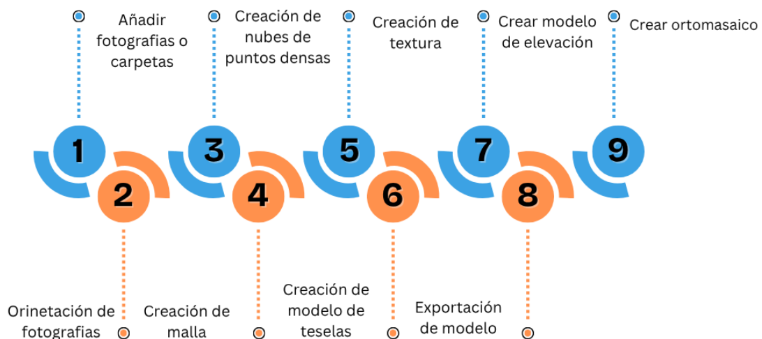
Figura 30 - Flujo de procesamiento de imágenes para modelos 3D en Agisoft Metashape .
