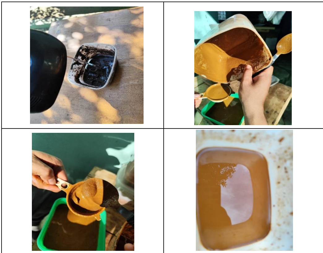
Figura 16: Homogeneización y filtrado de las tierras
