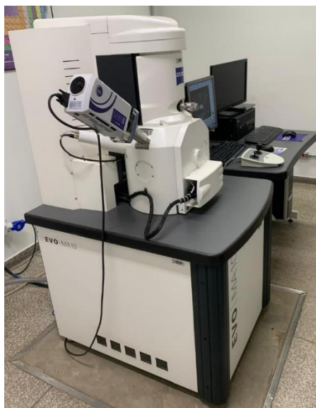
Figura 33 – Microscópio eletrônico de varredura (MEV) Zeiss EVO-MA10, acoplado ao detector de espectroscopia de dispersão de energia (EDS) INCA x-act da Oxford Instrument (modelo 51-ADD0048)
