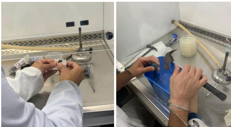
Figura 5 - Preparação das Amostras: a) Processo de limpeza da superfície das amostras de pedra; b) Processo de fragmentação das amostras de pedra
