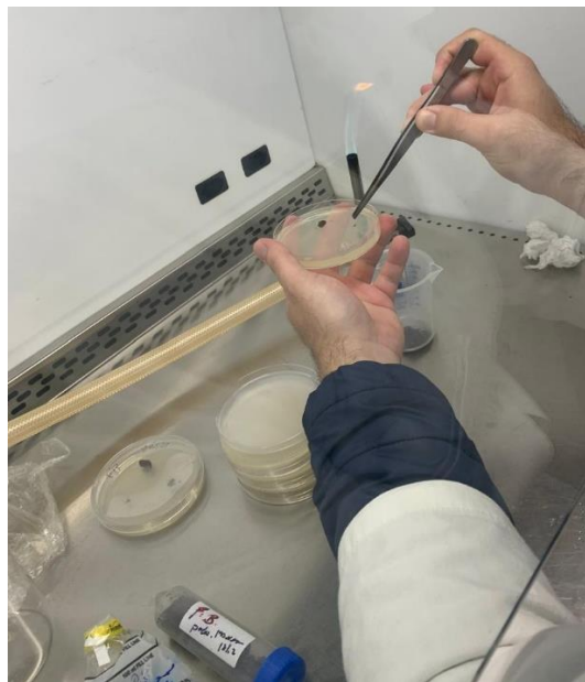
Figura 6 – Processo de inoculação das amostras de pedra no meio sólido (NA com adição de nistatina)
