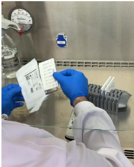
Figura 20 – Cartas GN sendo colocadas no Cassete VITEK® 2 COMPACT
