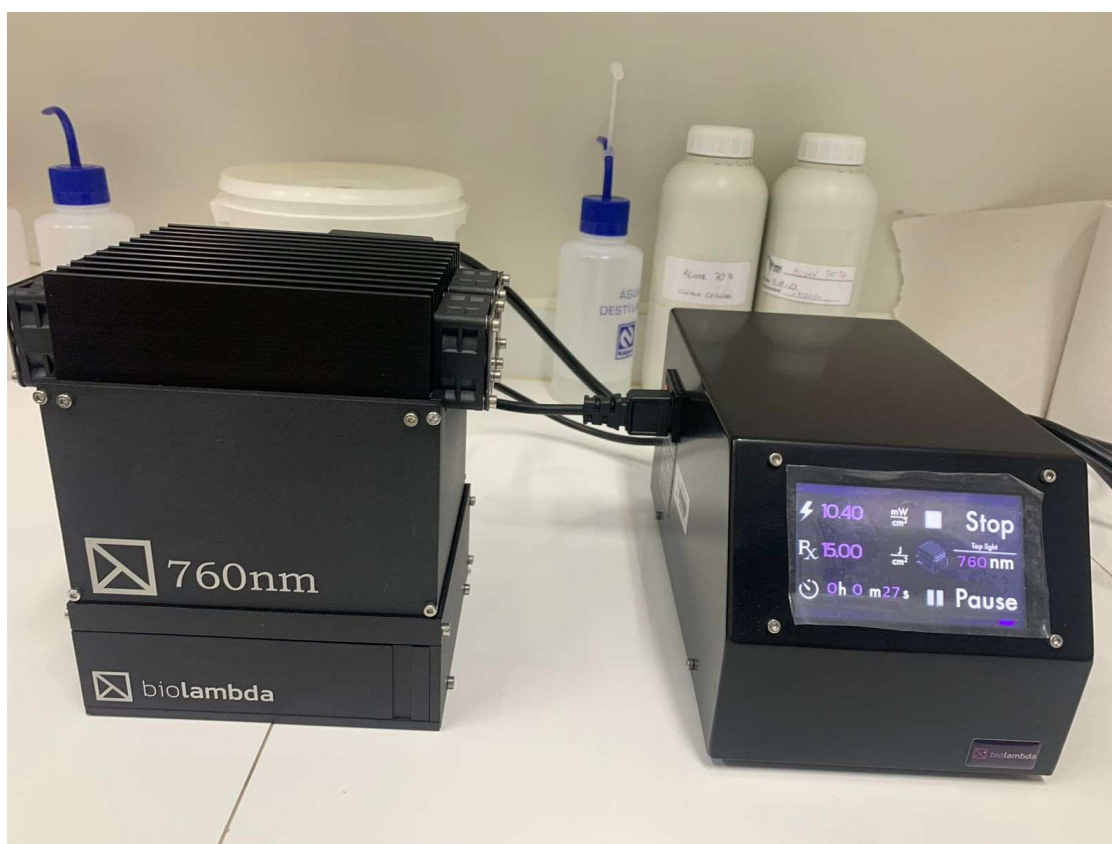
Figura 14: Biotable (Empresa Biolambda) – LEDs 760 nm. Nessa biotable é possível regular a irradiância e a dose de luz, em \text{J}/\text{cm}^2 .
