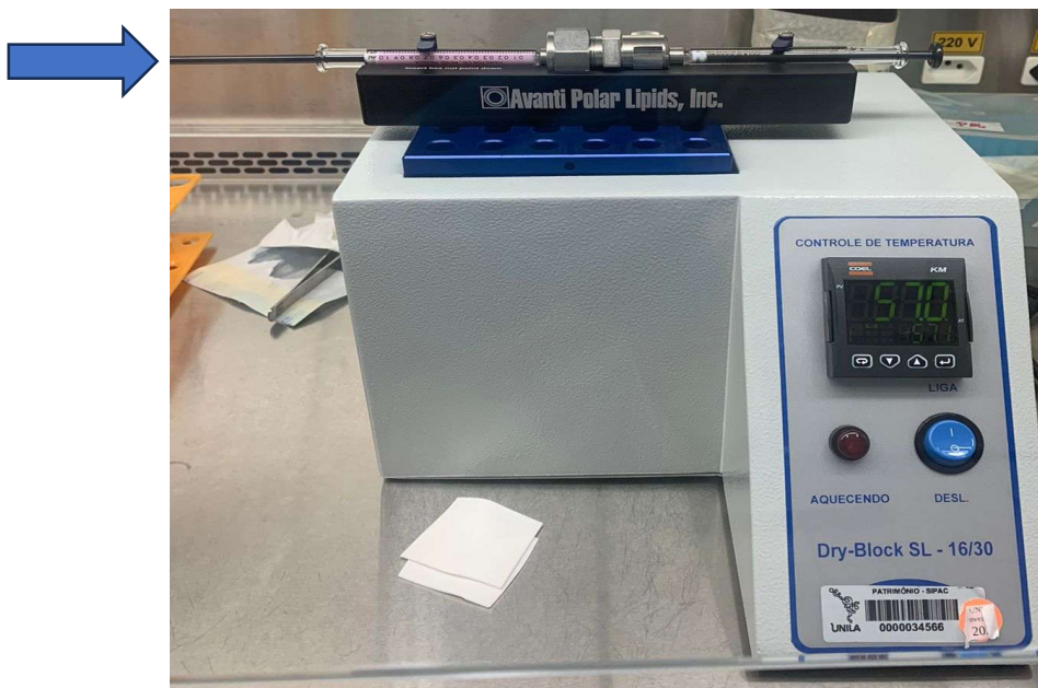
Figura 10: Foto da formulação de lipossomas com bacterioclorina (cor púrpura) em mini extrusor sobre o bloco de aquecimento.
