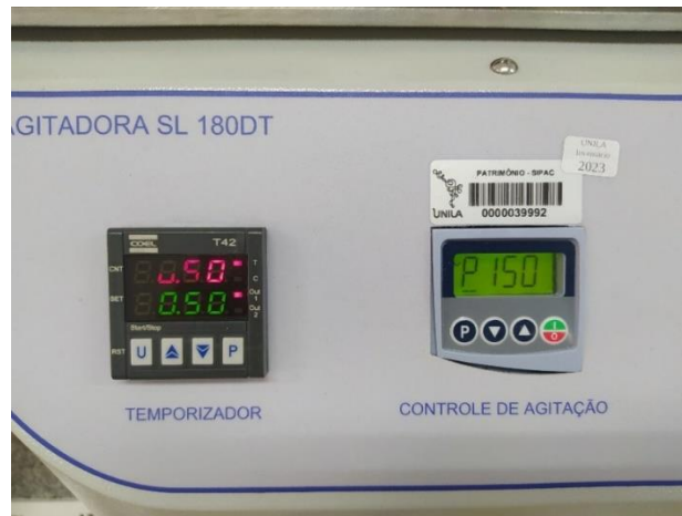
Figura 7: Agitador orbital utilizado para homogeneizar as amostras.
