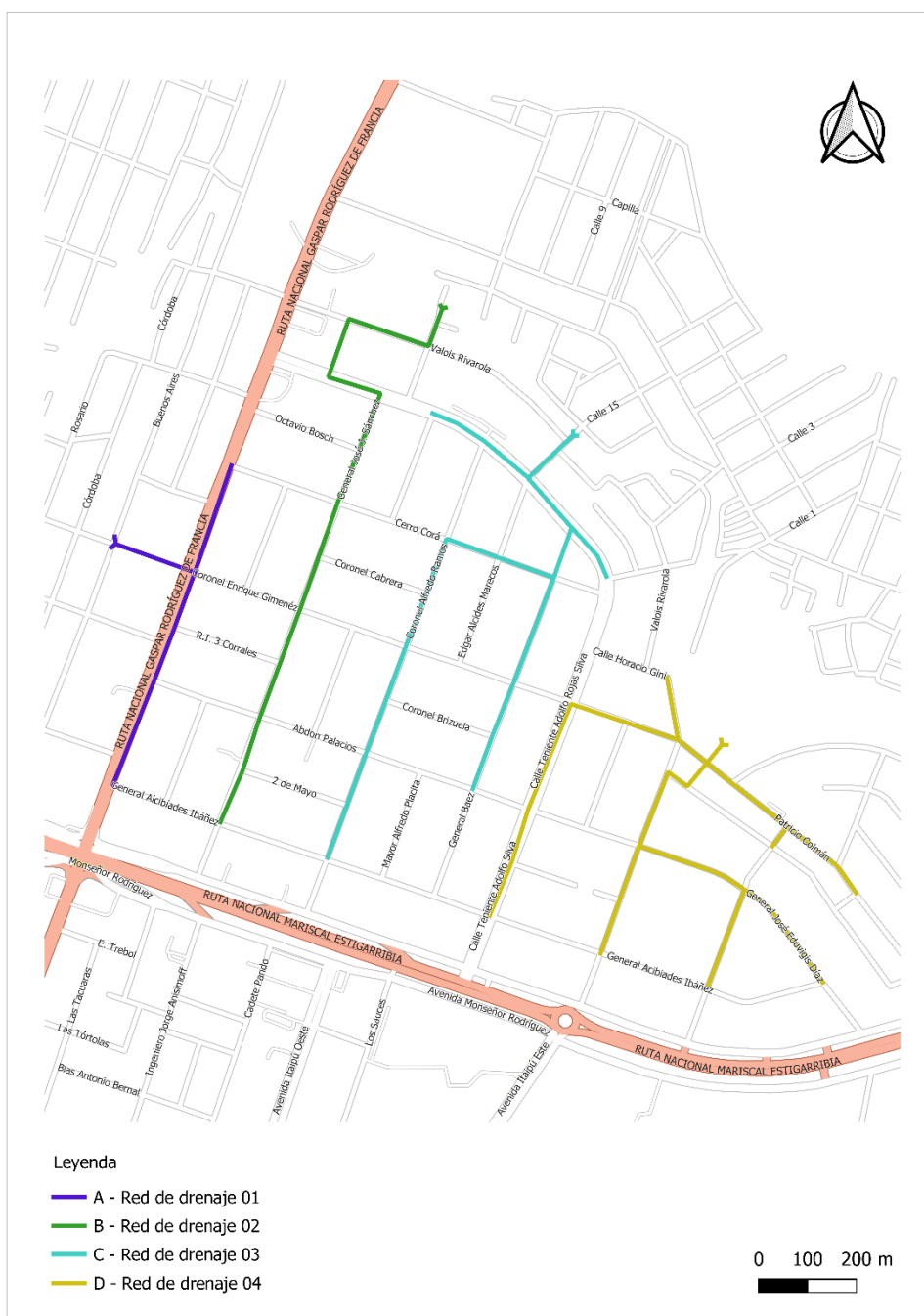
Figura 18 – Trazado del Sistema de Drenaje Pluvial.
