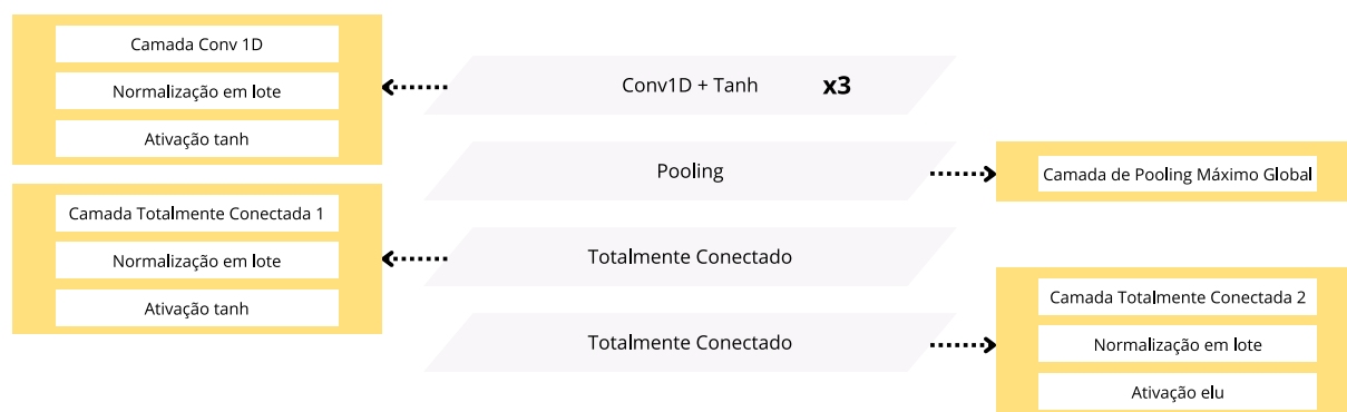
Figura 2.1: Estrutura 1D CNN. Adaptada de Qian et al. (2021) [44]
