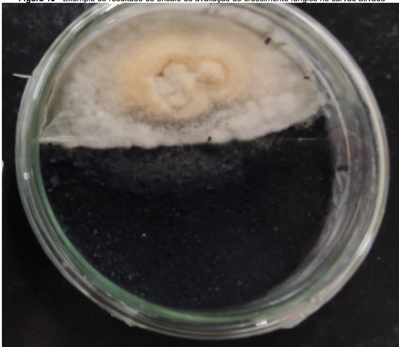
Figura 13 - Exemplo do resultado do ensaio de avaliação do crescimento fúngico no carvão ativado
