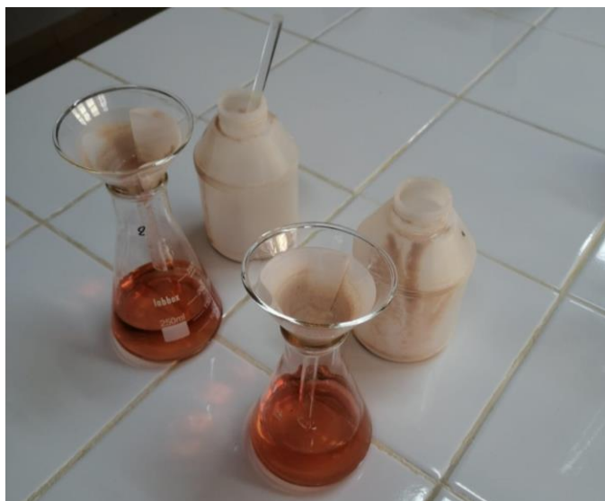
Fotografia 3. Filtração da amostra após passar pelo processo de adsorção.
