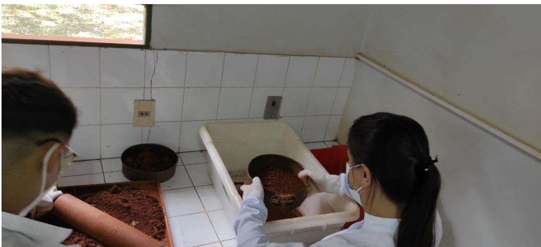
Fotografia 6. Condicionamento de amostras de solo antes da análise (trituração e peneiramento).
