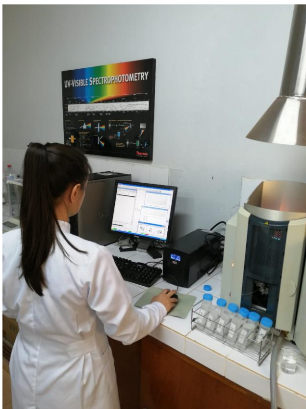
Fotografia 4. Análise das amostras com o espectrofotômetro de absorção atômica.
