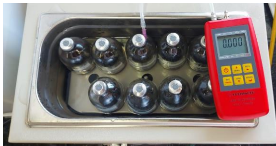
Figura 6 - Biodigestores em banho-maria.
