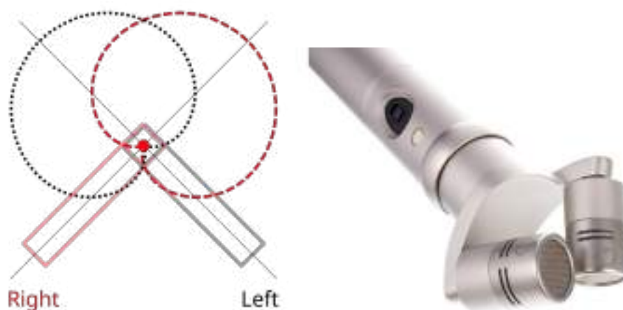
Figuras 47 e 48: microfonação em X/Y e microfone Rode NT4
