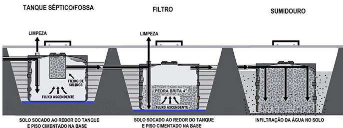
Imagem 6: Fossa/Tanque Séptico (filtragem anaeróbia).
