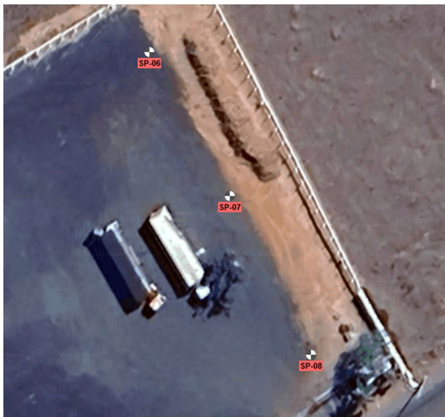
Figura 7 – Croqui dos pontos de sondagem da Região B.
