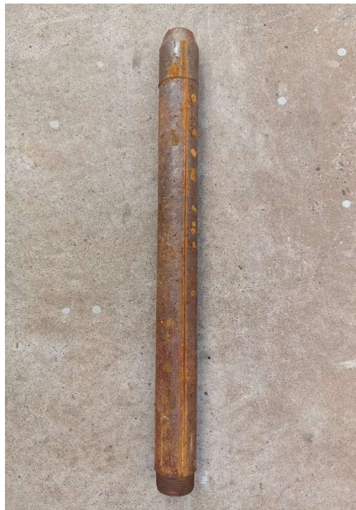
Figura 4 - Amostrador padrão de sondagem com presença de oxidação.
