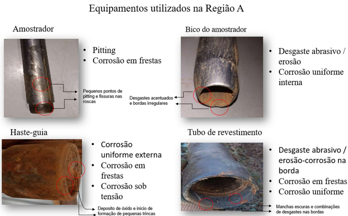
Figura 17 - Equipamentos utilizados na Região A e principais tipos de danos observados.
