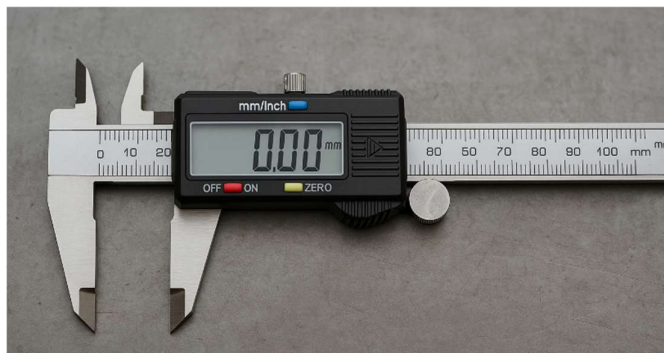
Figura 16 – Paquímetro digital utilizado para aferir, com precisão de 0,01 mm.
