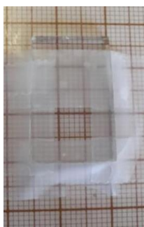
Figura 5. (a) ITO sobre o papel milimetrado e fixado por fita 3M e pronta para receber a deposição do material. (b) Placa de vidro após o processo de espalhamento e retirada da fita.
