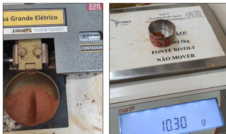
Figura 26 - Ensaio de Limite de Liquidez da amostra de argila
