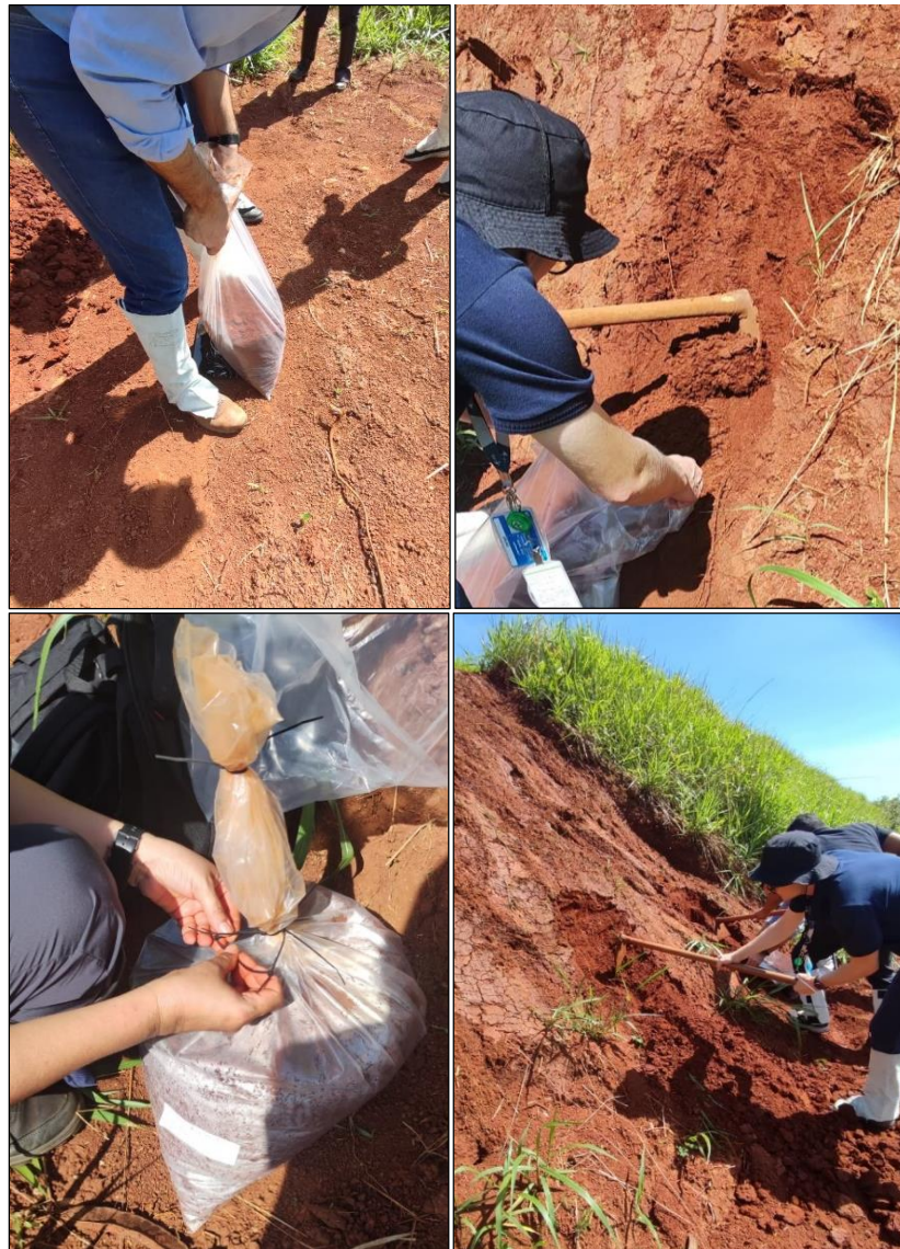
Figura 18 - Fotografias da coleta de amostras de solo deformadas
