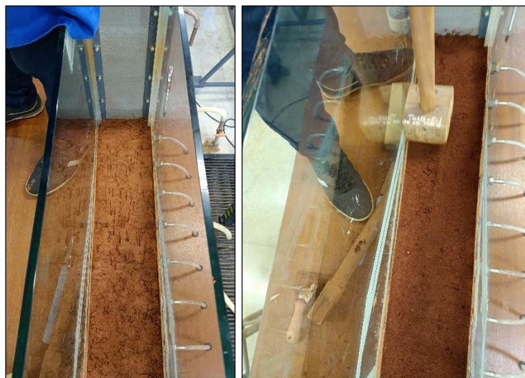
Figura 39 – Processo de compactação da camada de saprólito na fundação
