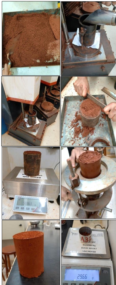
Figura 27 – Ensaio de compactação do solo de saprólito
