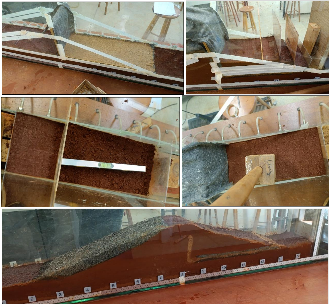
Figura 41 – Procedimento de compactação e modelagem do maciço
