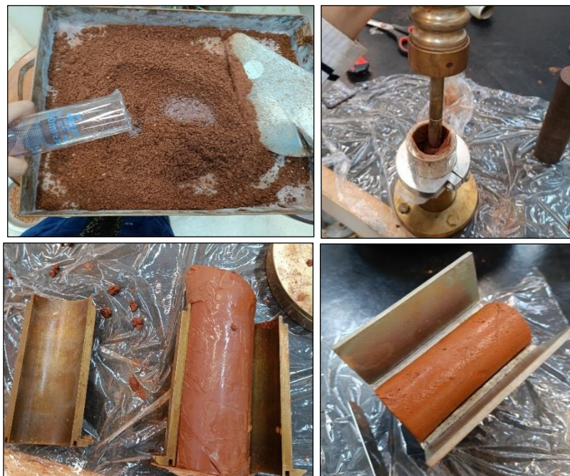
Figura 31 – Moldagem do corpo de prova de saprólito por compactação manual
