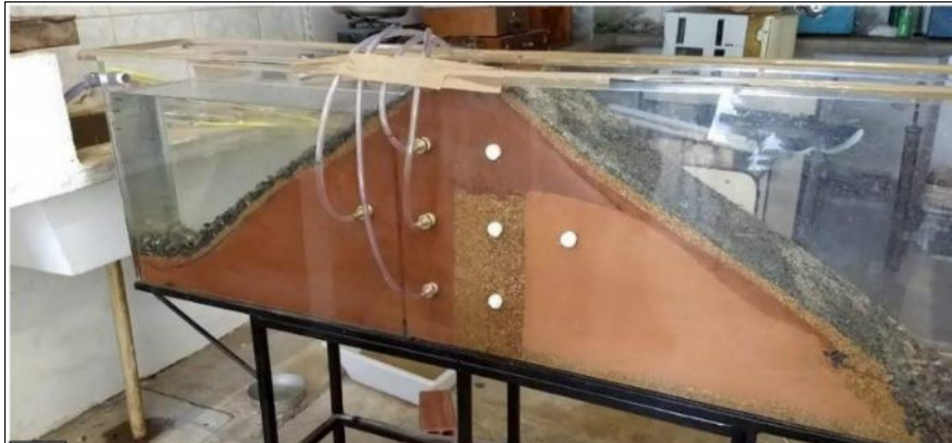
Figura 8 – Modelo reduzido de uma barragem homogênea
