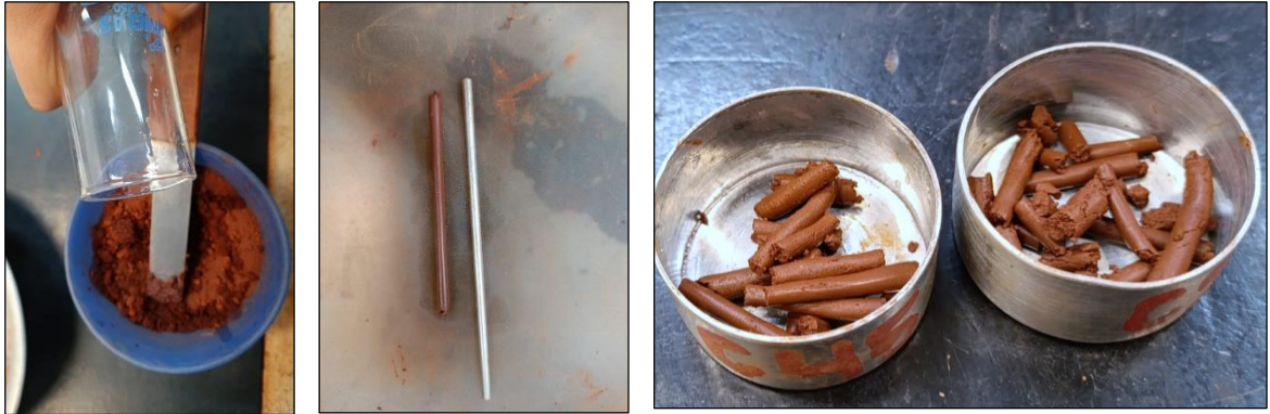
Figura 24 - Ensaio de Limite de Plasticidade do solo de argila
