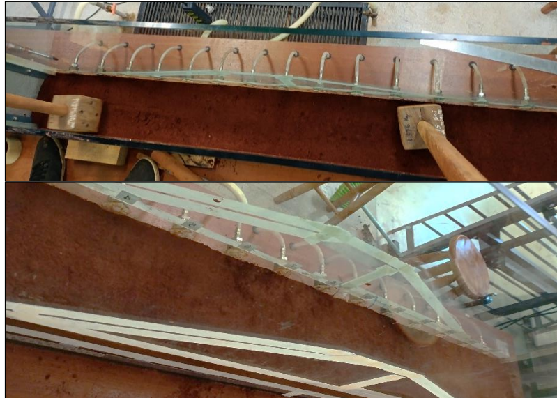
Figura 40 – Processo de compactação da camada de argila na fundação
