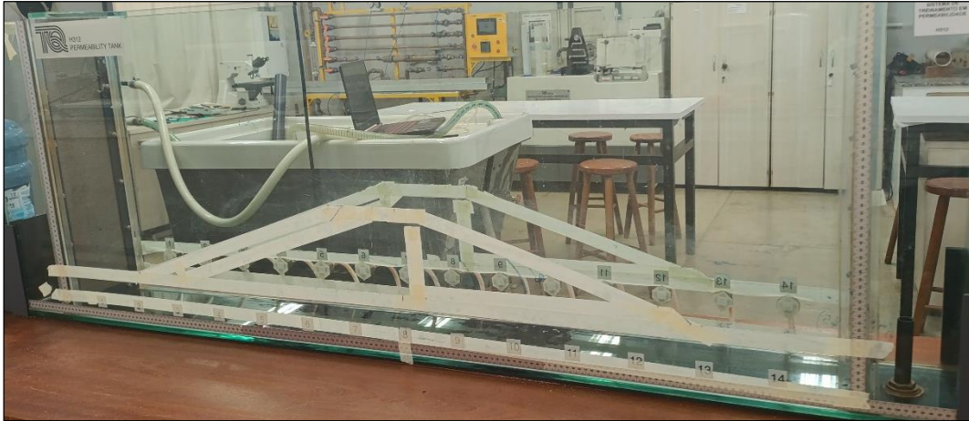
Figura 38 – Marcação da geometria no vidro
