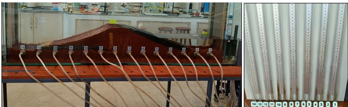
Figura 51 – Leituras piezométricas no modelo físico
