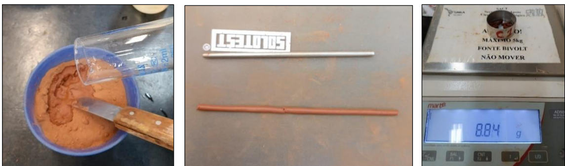
Figura 23 – Ensaio de Limite de Plasticidade do solo de saprólito
