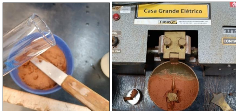
Figura 25 – Ensaio de Limite de Liquidez da amostra de saprólito
