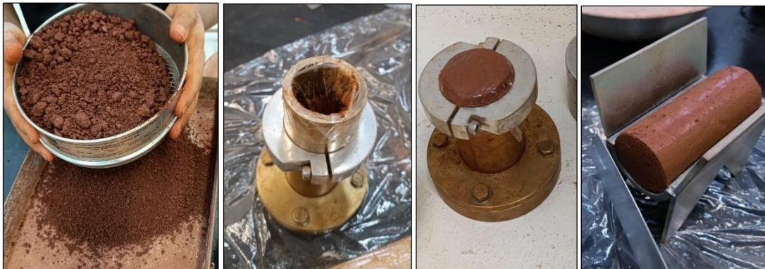
Figura 29 – Moldagem do corpo de prova mediante compactação manual
