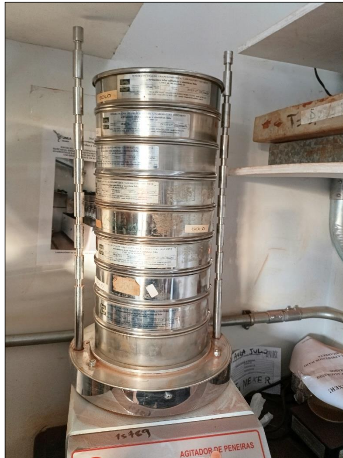
Figura 22 – Faixa de peneira utilizadas no ensaio
