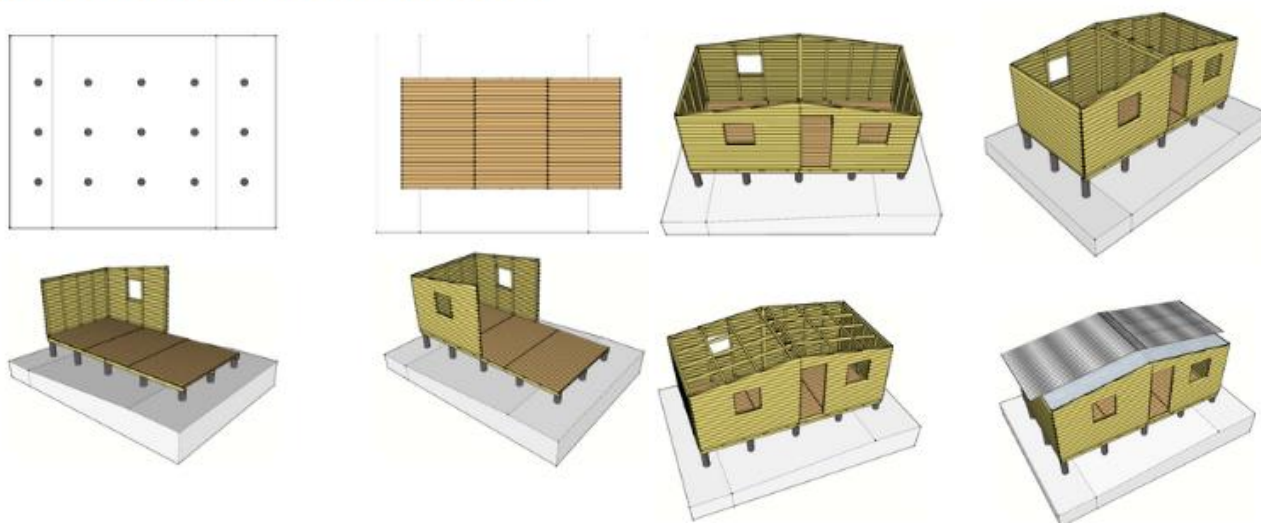
Ilustración 23. Metodo Actual de construccion TECHO PY.
