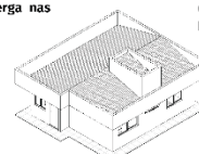
e) Beiral com platibanda, avançando todo o perímetro da edificação
