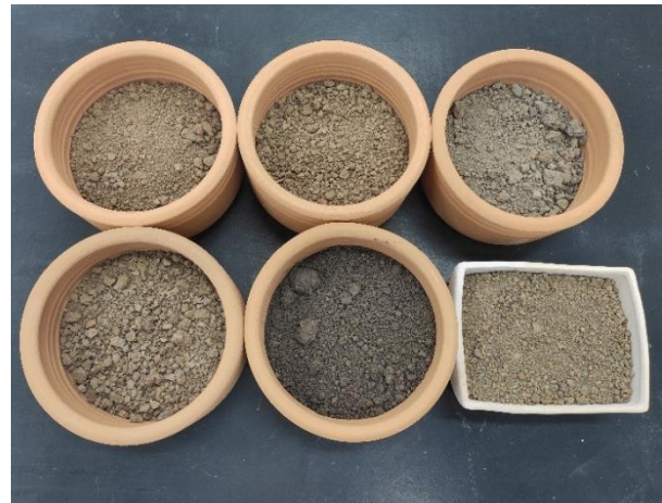
Figura 3.6 – Recipientes cerâmicos utilizados para a calcinação das argilas
