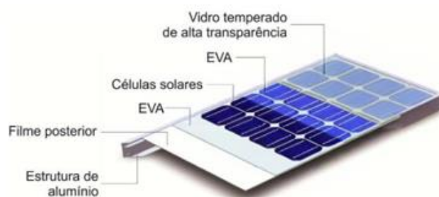
Figura 8 - Esquema de los componentes de un módulo fotovoltaico con células de silicio cristalino. (Fuente: PINHO, et. al. , p.132, 2014).
