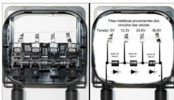
Figura 12 - Caja de conexiones y diagrama de ligaciones de un módulo de 240 Wp, con 60 células en serie (20 para cada diodo), donde V_{OC} = 36,9 \text{ V} . (Fuente: Adaptado de PINHO, et. al. , p.155, 2014).
