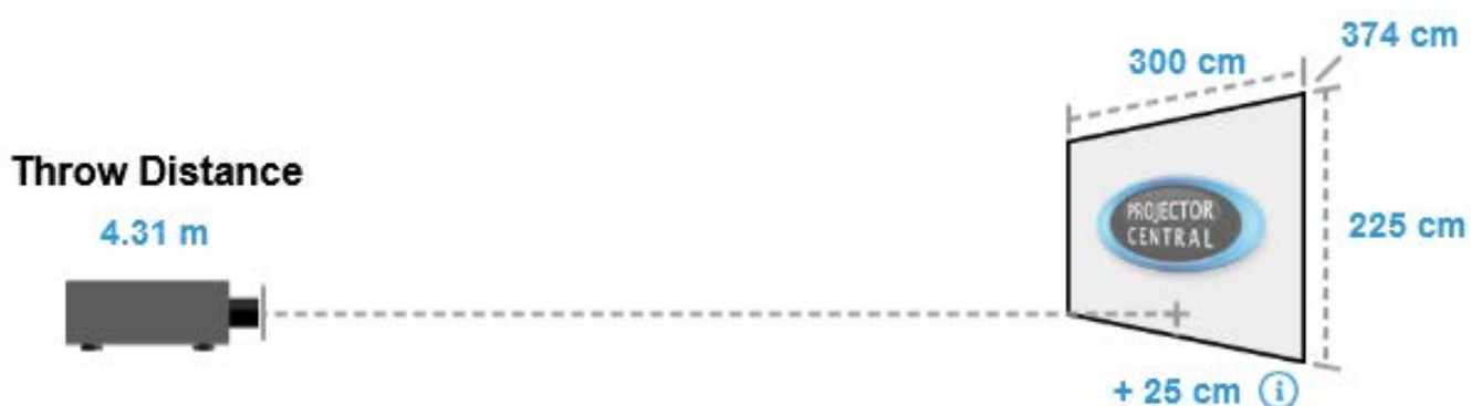
FIGURA 7.8 - Distância e tamanho da projeção calculada através do Projector Central Fonte: Autor
