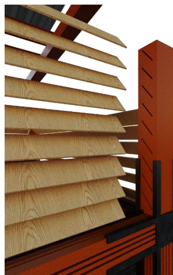
Figura 88 - Detalhe encaixe 45° brise-soleil
