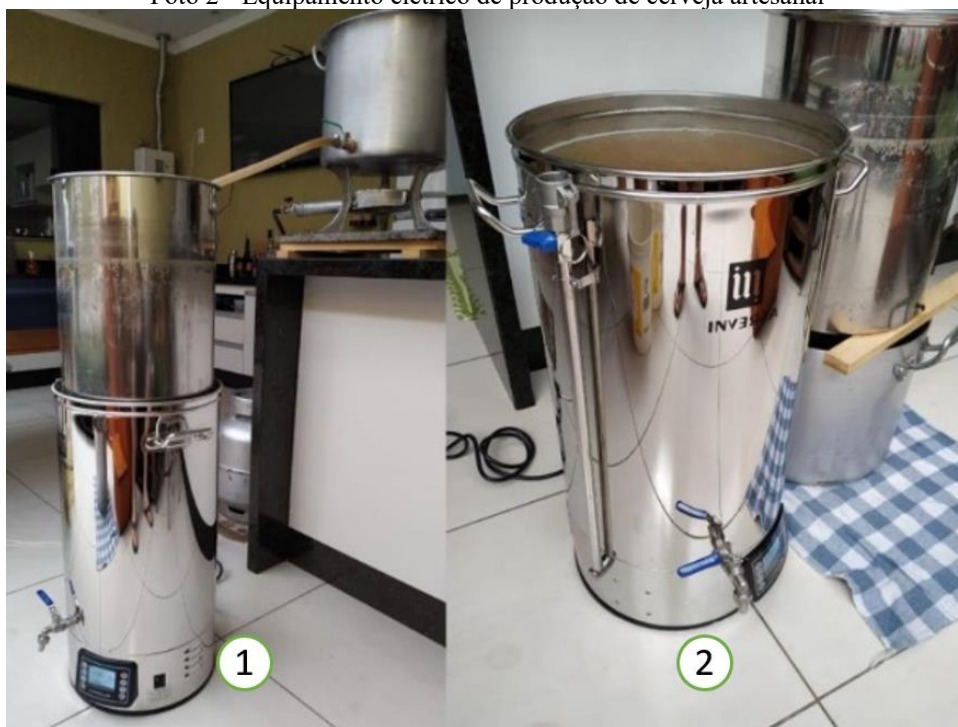
Foto 2 - Equipamento elétrico de produção de cerveja artesanal
