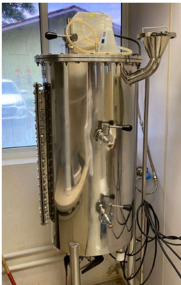
Figura 5 – Reator anaeróbio de mistura completa
