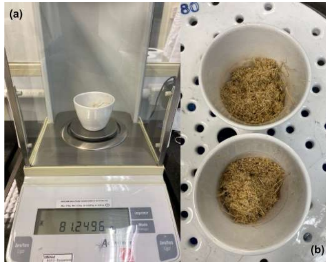
Figura 3 – Processo de pesagem da amostra para o registro das massas (a); duplicata de cadinhos contendo a amostra no dessecador (b)
