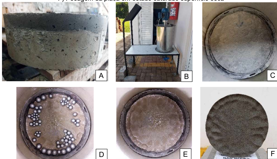
Figura 17 – Procedimentos empregados no ensaio de perda de massa por abrasão hidráulica A) Placa circular B) Equipamento de abrasão C) Placa no equipamento antes do ensaio D) Placa com as esferas no equipamento após o ensaio E) Placa no equipamento após o ensaio F) Pesagem da placa em estado saturado superfície seca
