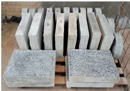
Figura 7 – Armazenamento ao ar das placas após o desgaste por jato de areia
