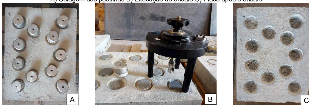
Figura 16 – Procedimentos empregados para o ensaio de resistência de aderência à tração A) Colagem das pastilhas B) Execução do ensaio C) Placa após o ensaio
