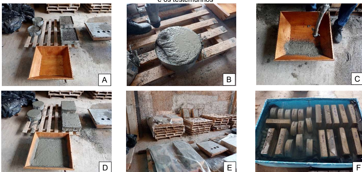
Figura 14 – Procedimentos empregados na projeção e cura das placas e testemunhos
