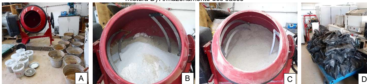
Figura 12 – Procedimentos empregados na mistura, ensacado e armazenamento dos sacos de argamassa A) Preparação de materiais para a mistura B) Colocação dos materiais na betoneira C) Argamassa seca após a mistura D) Armazenamento dos sacos
