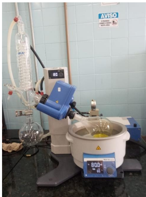
Figura 12 - Rota evaporador usado para secagem
