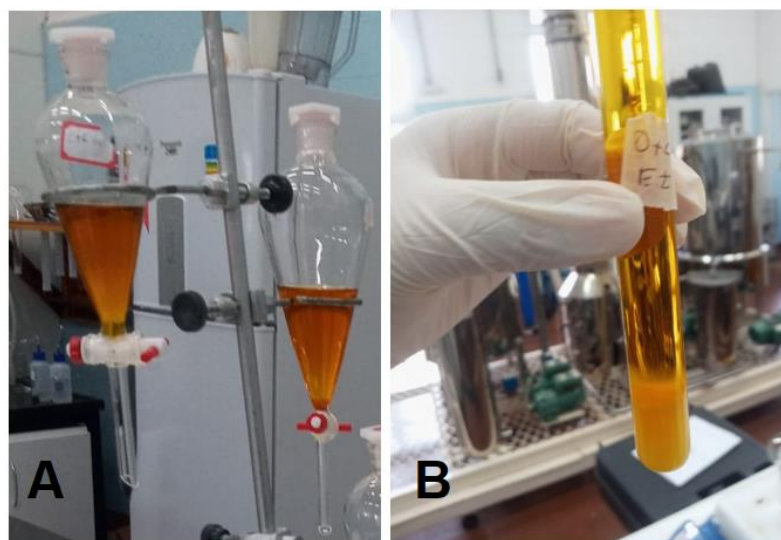
Figura 19 - Reação de Etanolise que não ocorreu
