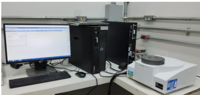
Figura 15 - Analisador termogravimétrico da Perkin Elmer - STA 8000
