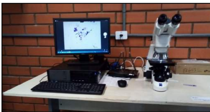
Ilustración 9: microscopio óptico utilizado para la adquisición de imágenes.
