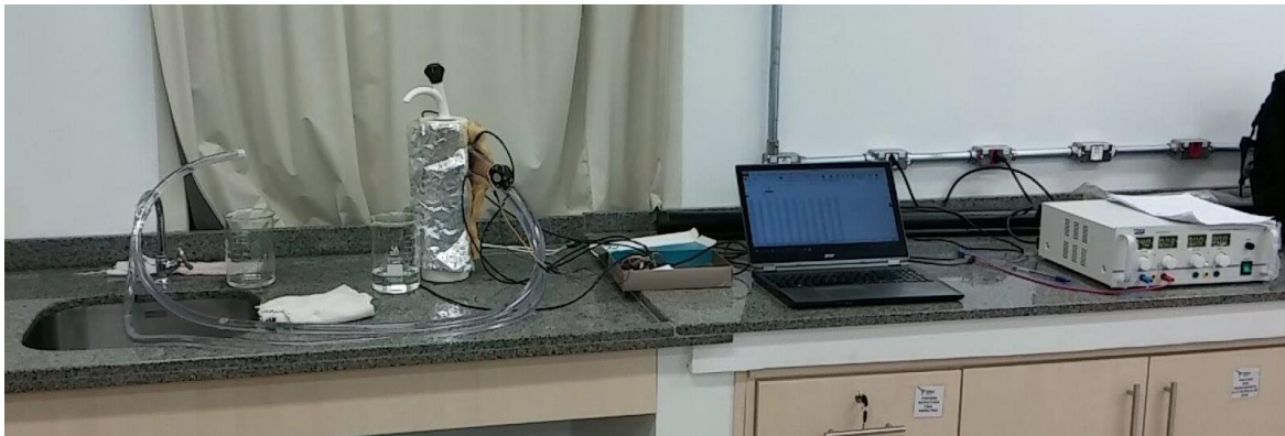
Fig. 5 Fotografía de la bancada experimental. De izquierda a derecha, entrada y salida del agua corriente, termosifón dentro de los tubos de PVC aislados con lana de vidrio (se observa la canilla utilizada para el sangrado del sistema), interfaz de Arduino© para los sensores y el sistema de adquisición de datos(computador), finalmente se observa la fuente regulable de tensión/corriente.
