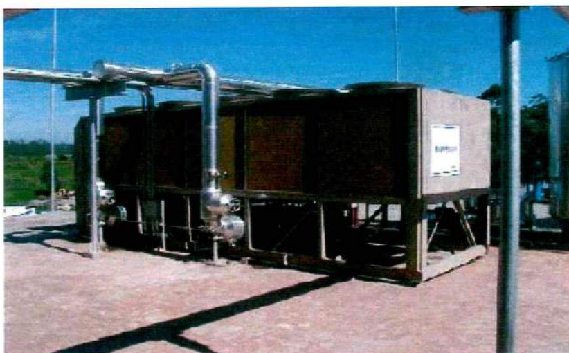
Figura 7 – Sistema de pré-tratamento de gás de aterro.
