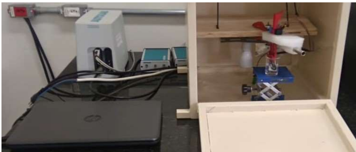
Fotografia 1 – Aparato experimental para medidas eletroquímicas.
