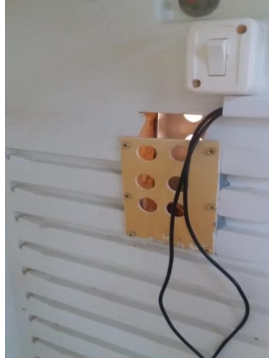
Figura 4 - Tapa plástica de ingreso con tornillos.
