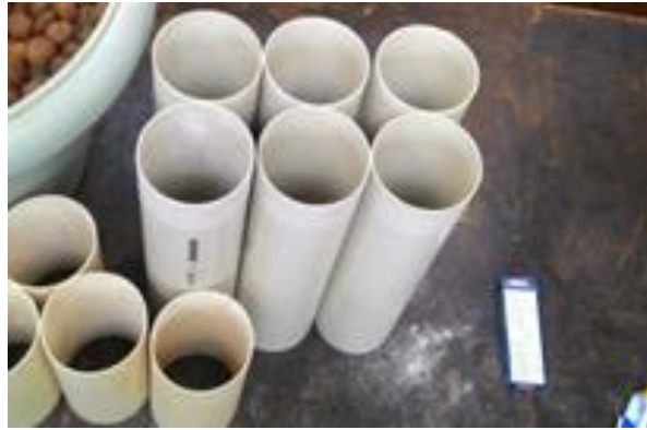
Figura 7 - Corte de los caños de PVC.
