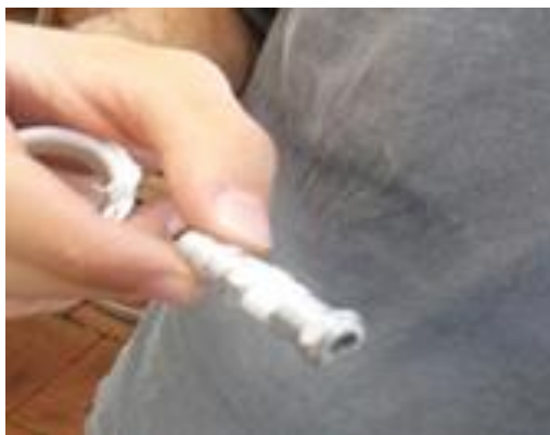
Figura 11 - Colocación de teflón en el inyector.
