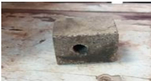
Figura 16 – Ladrillo refractario para soporte de resistencia.
