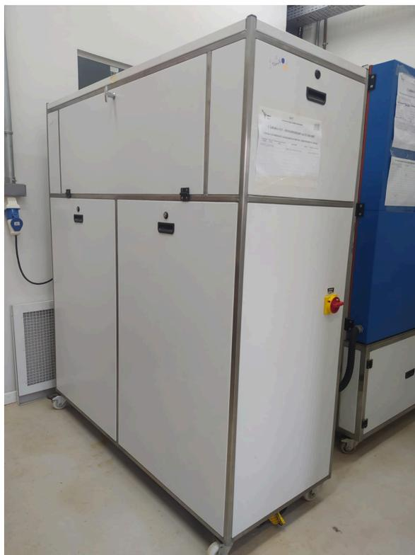
Esta câmara é capaz de simular ambientes com radiação UV (320 a 400 nm), umidade e calor. Para este ensaio, o ciclo de envelhecimento da câmara foi programado para durar 12 horas, realizando 8 horas de emissão de radiação UV, seguidas de 4 horas de umidade, sempre com temperatura constante de 25°C. Foram dispostas 10 amostras na câmara e a cada ciclo finalizado uma amostra era removida. Assim, as amostras foram submetidas de 1 a 10 ciclos de envelhecimento acelerado.
