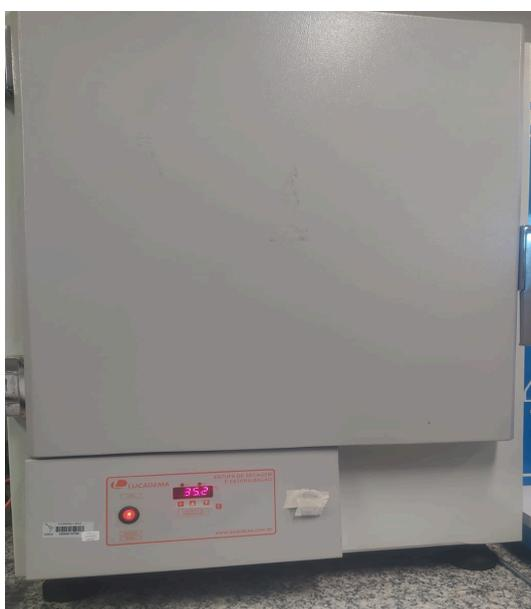
Diversas temperaturas foram empregadas no ensaio, sendo elas: 30, 35, 40, 45, 50, 60, 70, 80, 90, 93, 97 e 100°C. Cada filme de PEAD/PANI foi submetido a uma dessas temperaturas por um período de 24 horas. Dessa forma, este ensaio foi realizado em 12 amostras.
