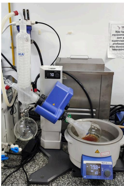
A anilina impura (cor marrom) foi adicionada ao frasco de evaporação e colocada em banho de água a 80°C com rotação de 70 rpm. Neste processo, a anilina purificada (incolor) é condensada e armazenada no frasco de recepção conectado à coluna de condensação vertical. Após a destilação, o volume de anilina purificada foi armazenado em ambiente refrigerado e livre de luz, para evitar sua oxidação.
