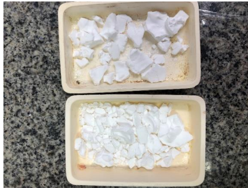
Figura 14 – Produto obtido da Amostra 2 após o processo de calcinação.
