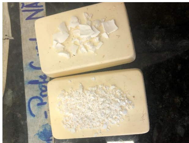
Figura 13 – Produto obtido da Amostra 1 após o processo de calcinação.
