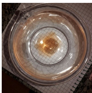
Figura 1 – Fotografia das membranas Nafion 117 após o tratamento químico, em água.
