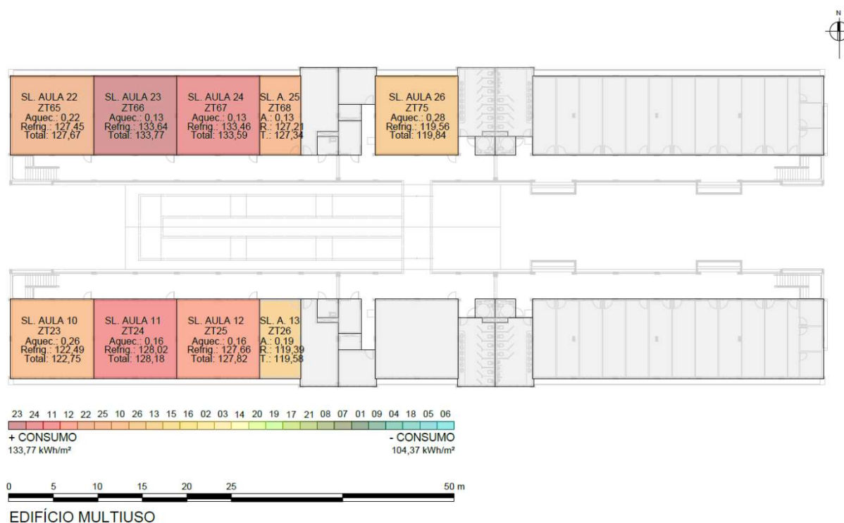
Figura 5.26. Planta Baixa do Pavimento Superior com consumo para aquecimento, refrigeração e total por m 2
