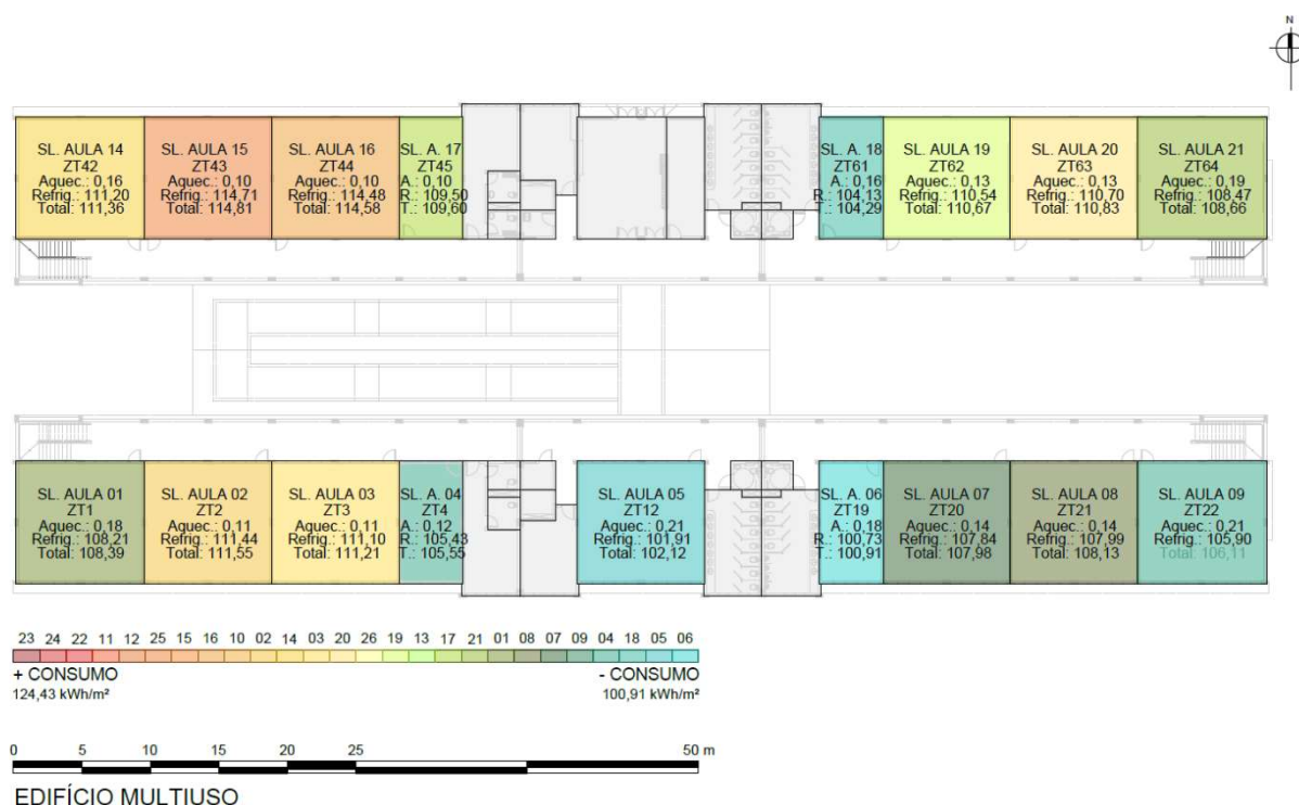
Figura 5.81. Telha de fibrocimento pintada de branco - Planta Baixa do Pavimento Térreo com consumo para aquecimento, refrigeração e total por m 2
