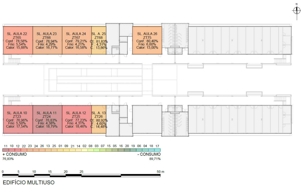
Figura 5.107. Integração de estratégias projetuais - Planta Baixa do Pavimento Superior com percentuais de conforto e desconforto térmico
