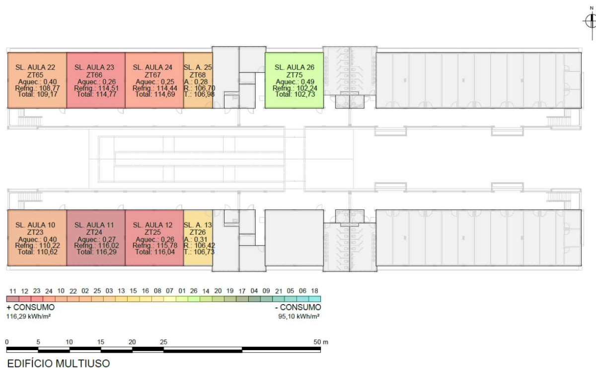
Figura 5.103. Integração de estratégias projetuais - Planta Baixa do Pavimento Superior com consumo para aquecimento, refrigeração e total por m 2
