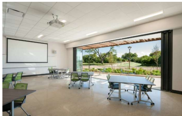
Figura 3.48. Grandes aberturas cobertas por beirais favorecem a circulação de ar nas salas de aula
