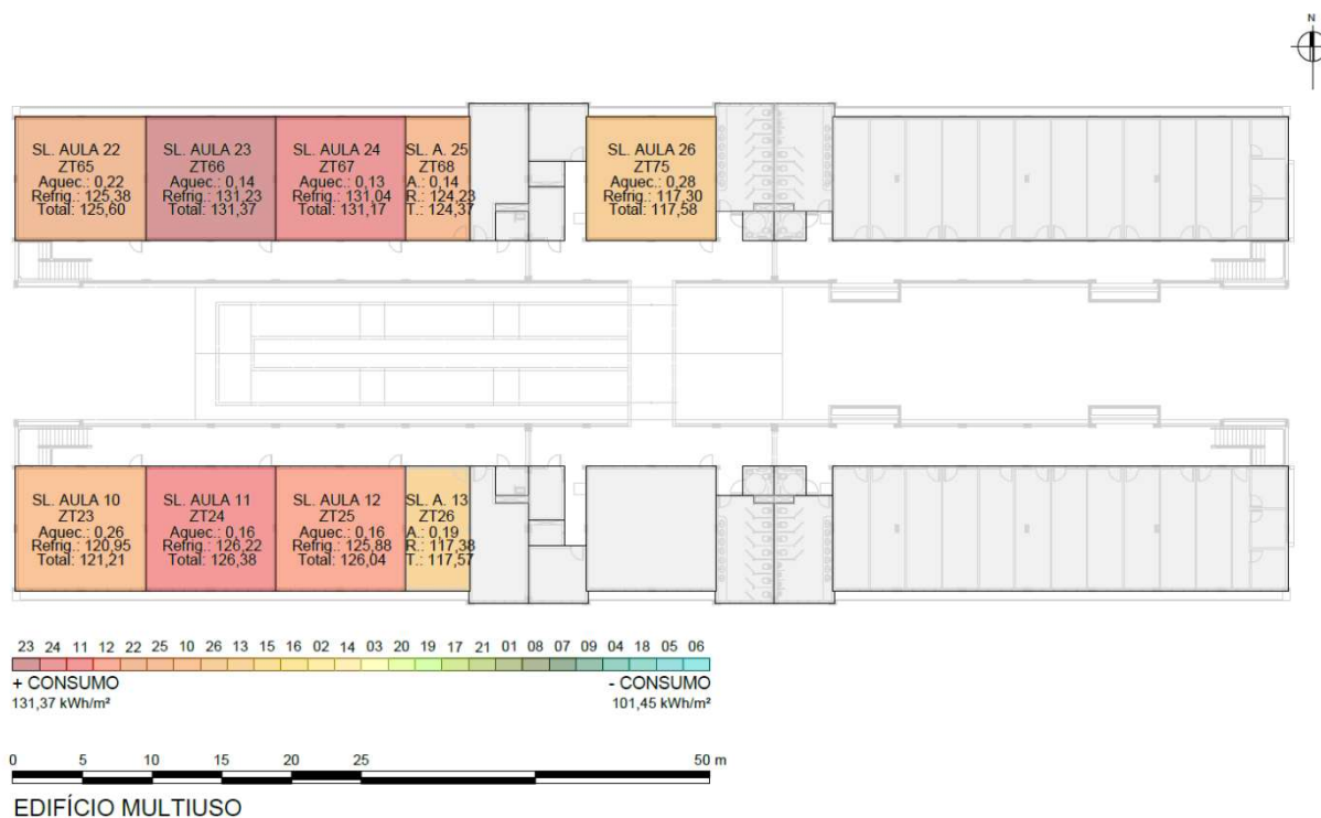
Figura 5.64. Vidros verdes de 6mm - Planta Baixa do Pavimento Superior com consumo para aquecimento, refrigeração e total por m 2
