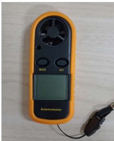
Figura 4.6. Anemômetro Anself H4326 utilizado para medição in loco
