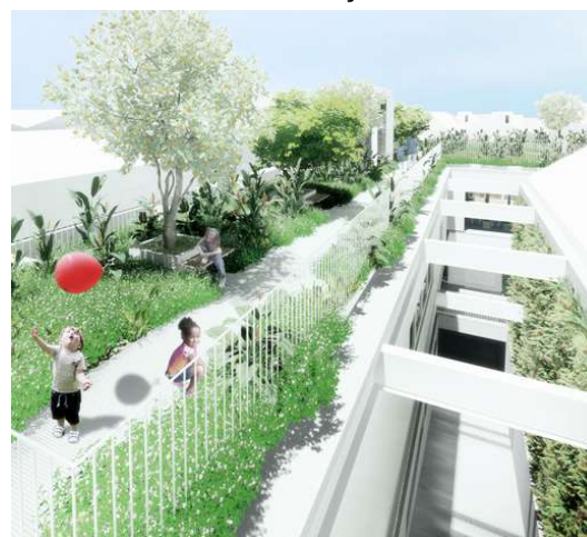
Figura 3.28. O telhado verde da cobertura minimiza a absorção de calor e serve como espaço de recreação
