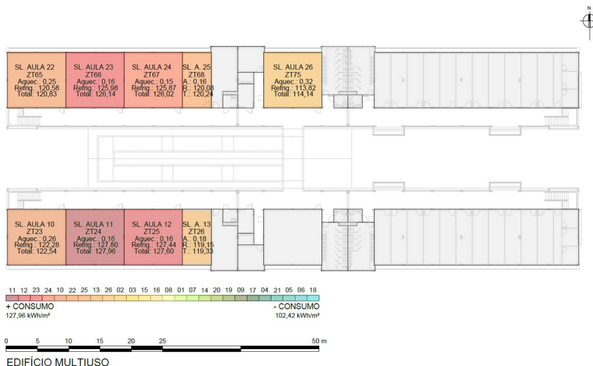
Figura 5.94. Brise horizontal na fachada norte - Planta Baixa do Pavimento Superior com consumo para aquecimento, refrigeração e total por m 2
