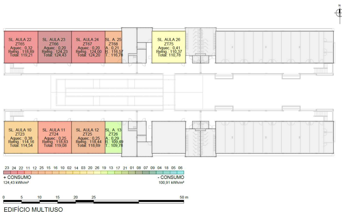
Figura 5.82. Telha de fibrocimento pintada de branco- Planta Baixa do Pavimento Superior com consumo para aquecimento, refrigeração e total por m 2
